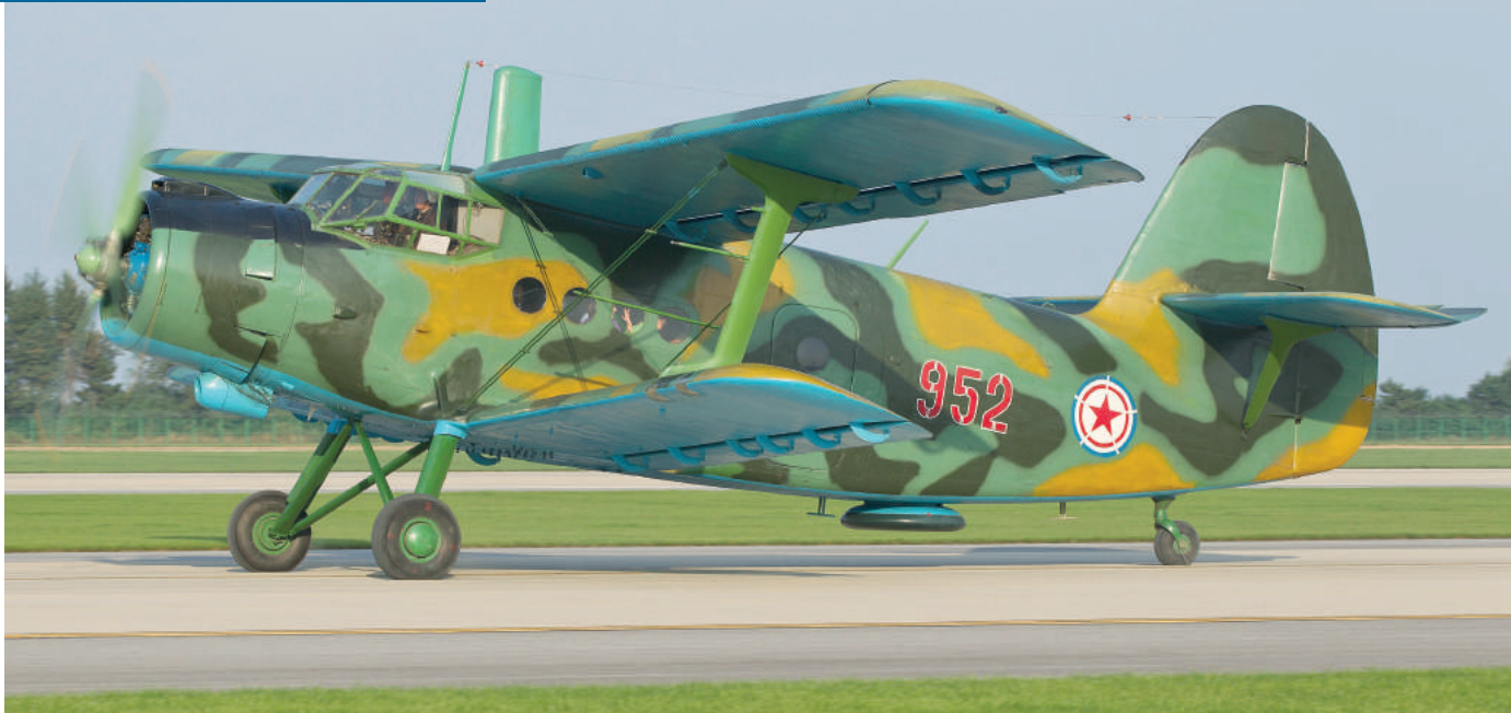
▲ Zmodernizowany An-2 z wydatnymi antenami zamontowanymi na górze i dole kadłuba. Część maszyn została wyprodukowana przez PZL Mielec.
